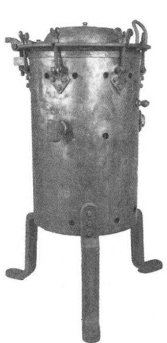
正式名称は「シンメルブッシュ氏煮沸消毒器」。用途は診療や手術時に使用する器械・器具類の煮沸消毒。消毒は100℃・約30分。中山艦に搭載、使用されたため熱源は蒸気仕様となっている。もう一台は「シンメルブッシュ氏乾燥装置附蒸気消毒器」で予め貯槽缶（丸形カスト）に繃帯材料・ガゼなどの物品を収納して、器内に収めた後、蒸気で消毒し、引き続き蒸気熱による乾燥を行う。作用は器体底部の煮沸槽内の水を加熱蒸発させる。発生した蒸気を器内に噴入させて100～105℃に達してから約30分間消毒を行う。続いて蒸気の噴入を切り替えて周
